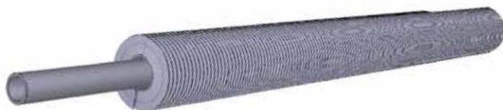
Производство биметаллических и монометаллических (алюминий) оребренных труб осуществляется на специальных станках ХПРТ (холодная прокатка ребристых труб) методом поперечно-винтовой прокатки.
